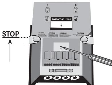
3. Fronplatte vorsichtig hochschieben bis zum STOP. Vor dem Frontplatten entfernen zuerst den Flachbandstecker ausstecken!
