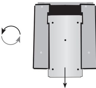
4. Metallene Montageplatte auf der Rückseite des Gerätes entfernen.
