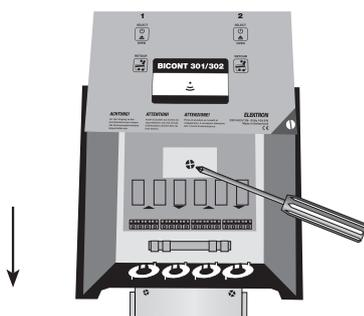
5. Führungsschienen des Gehäuses in Montageplatte einführen und Gehäuse langsam nach unten gleiten lassen. Das Gerät mit zentraler Schraube in der Mitte des Gehäuses sichern.
