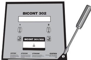
2. Schraube rechts unten an der Gerätefront lösen.
