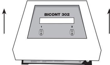
1. Abheben des Frontrahmens durch Ziehen. Der Rahmen ist nur geklemmt.
